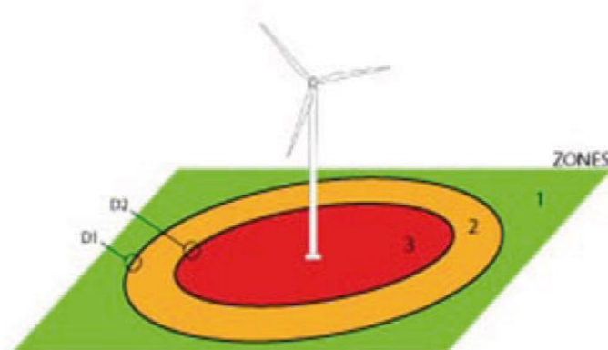
Figure 15 : Distances de sécurité entre une éolienne et un ouvrage de GRT gaz (Source : GRT gaz, région Nord-est)
